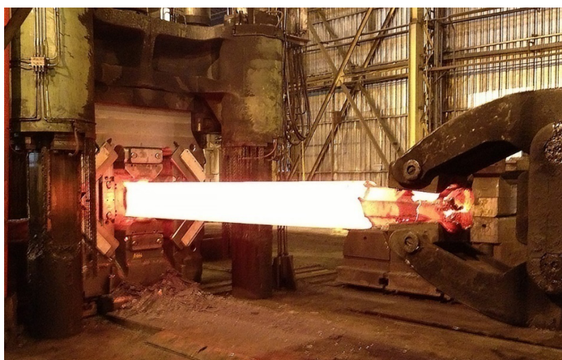
Ковка слитка из нержавеющей стали в FDFD на прессе ус. 30МН (Бразилия)
