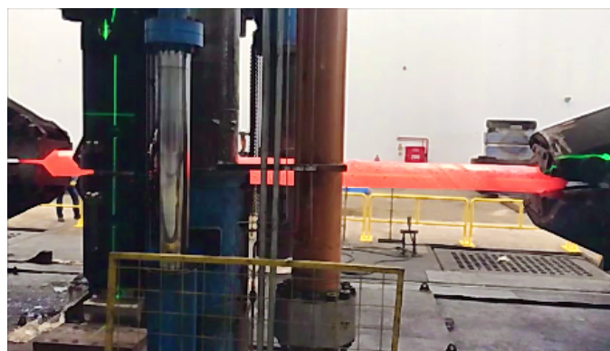
Ковка в FDFD на прессе ус. 40 МН с двумя манипуляторами (Турция)
