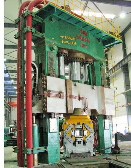
Использование ковочного блока на гидравлических прессах ус. 25МН и 45МН (Китай)
