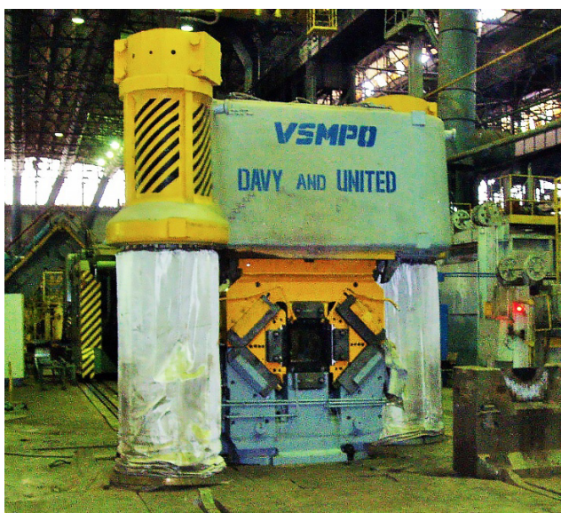
FDFD на прессе ус. 25МН дляковки заготовок из титана
