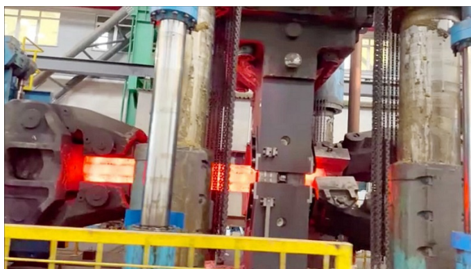
Ковка в FDFD на прессе ус. 40 МН с двумя манипуляторами (Турция)
