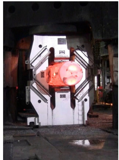
FDFD с бойками для получения поволоков квадратного сечения и с бойками для получения поволоков круглого поперечного сечения на прессе ус. 30 МН (Япония)
