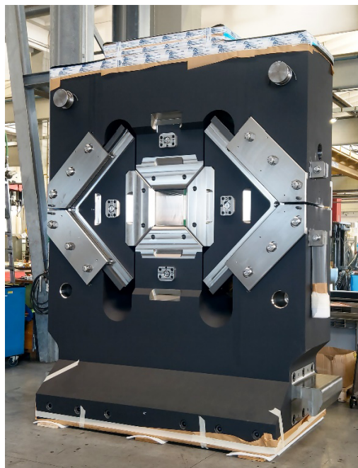
FDFD изготовленные в OMZ для прессов ус. 30 МН и 40 МН
