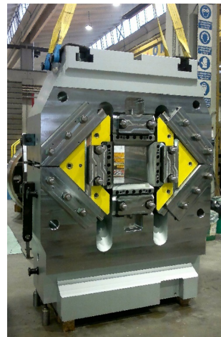
FDFD изготовленные в OMZ для прессов ус. 30 МН и 40 МН
