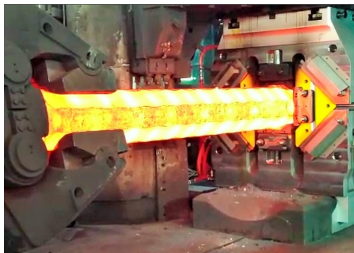
Ковка слитка из высоколегированной нержавеющей стали в FDFD на прессе ус. 30 МН (Италия)
