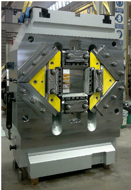
FDFD с креплением верхнего корпуса к прессу ус. 30 МН (Италия)
