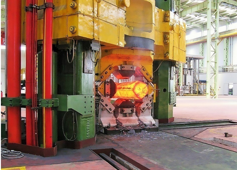
Использование ковочного блока на гидравлических прессах ус. 25МН и 45МН (Китай)
