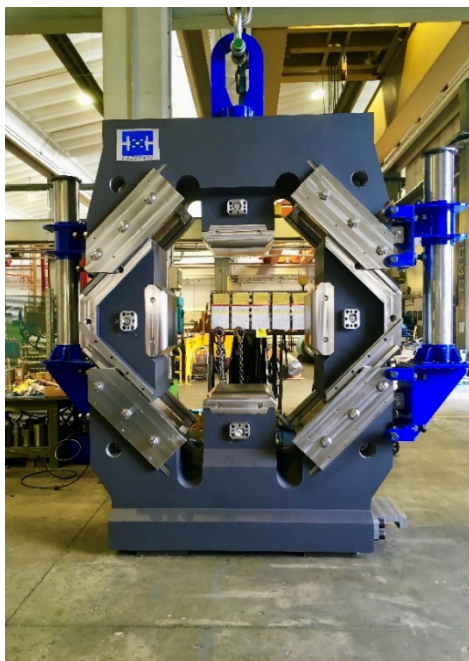
FDFD изготовленные в OMZ для прессов ус. 30 МН и 40 МН
